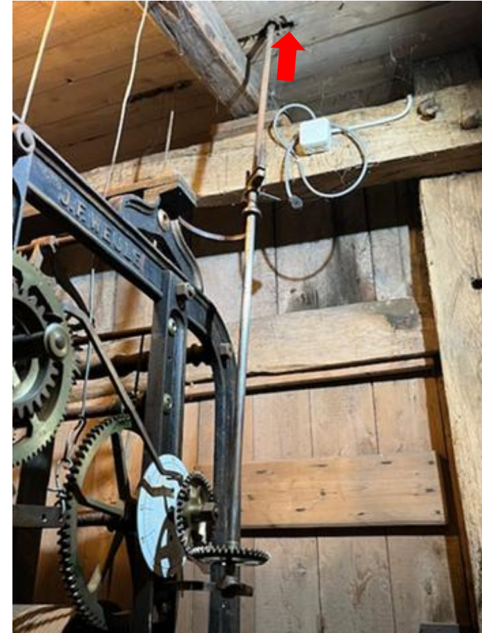
Minutenwelle – Abtrieb zur Zeigerstange
