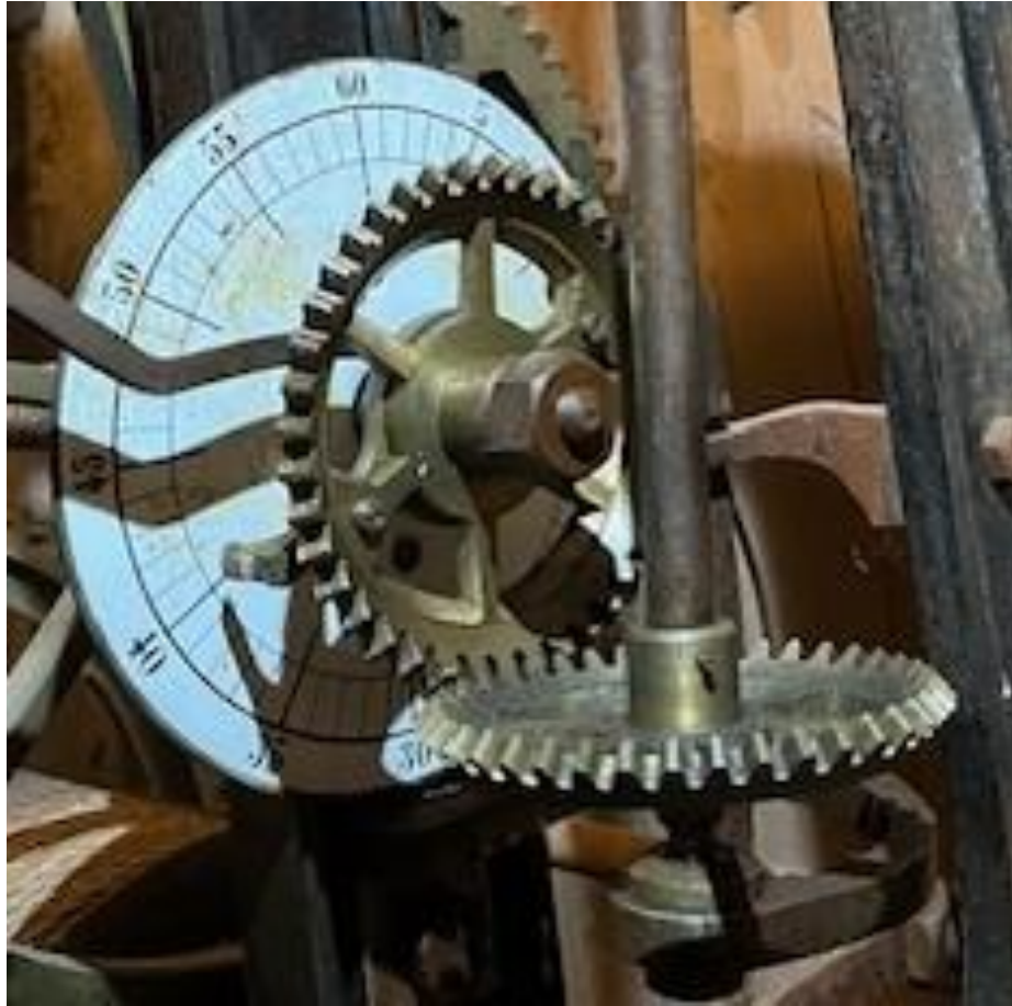
Gehwerk mit Kegel-Zahnrad Paar und Minutenwelle
